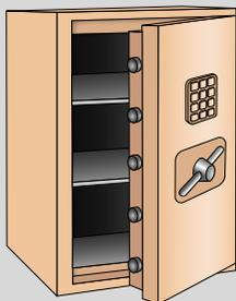
*Coffre-fort avec serrure à pêne dormant mécanique et verrouillage électronique (plaquette de certification apposée sur l'intérieur de la porte)*
